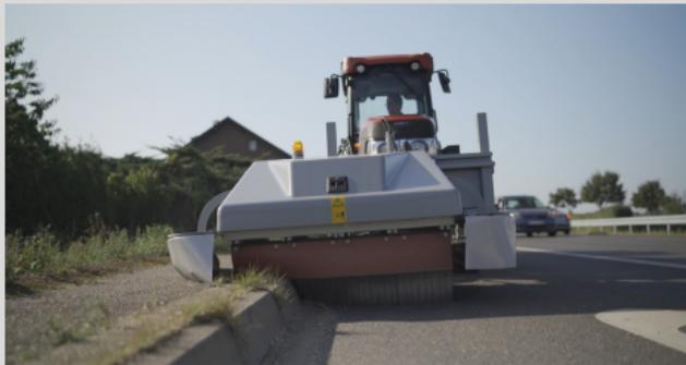
Im Vergleich zur mechanischen oder thermischen Unkrautbekämpfung wird der Untergrund durch unseren Unkrautmeister nicht aufgewirbelt und auch der Sand in den Fugen von Pflasterbelägen bleibt unversehrt. Die zerstörten Pflanzen bleiben an Ort und Stelle, wodurch neue Samen kein günstiges Saatbett zum Keimen haben.
